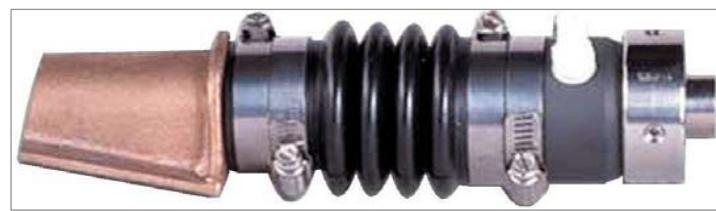
La tenuta meccanica **PSS** è un sistema di tenuta per assi portaelica senza manutenzione il quale garantisce una totale assenza di acqua in sentina. La tenuta meccanica è garantita dal contatto tra un anello di acciaio inox fissato sull'asse portaelica contro una flangia di carbonio/grafite installata sull'astuccio dell'asse tramite un soffietto di gomma.
