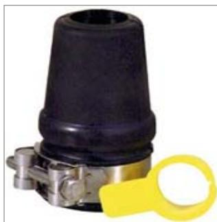
Di recente introduzione, questo è un sistema di tenuta in fusione di gomma di dimensioni compatte e di semplice installazione che permette di eliminare in modo definitivo l'ingresso di acqua in sentina. Richiede manutenzione ed ingrassaggio ogni 200 ore di moto o massimo una volta l'anno.
